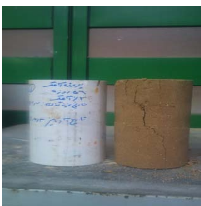
شکل ۲-۶ نحوه شکست نمونه پس از انجام آزمایش مقاومت فشاری
