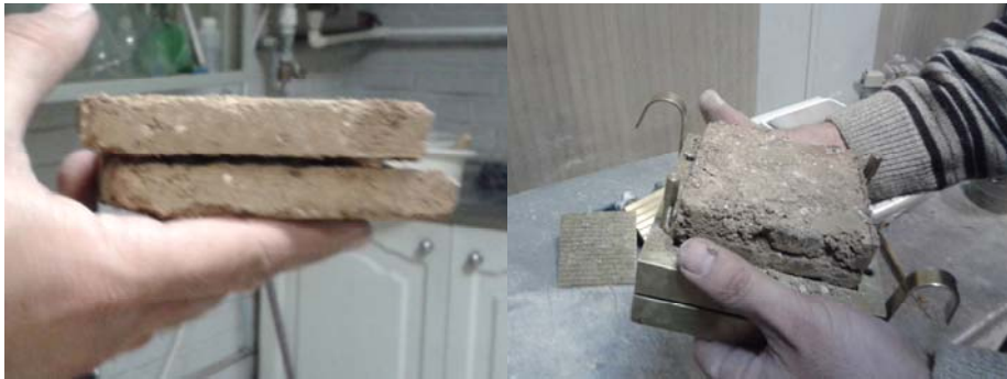
شکل ۲-۹ نمونه‌هایی از نحوه شکست نمونه پس از انجام آزمایش مقاومت برش مستقیم
